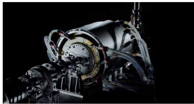
今回開発した超電導モーターの試作機
