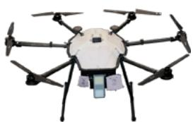
ドローン捕獲用自律飛行ドローン
