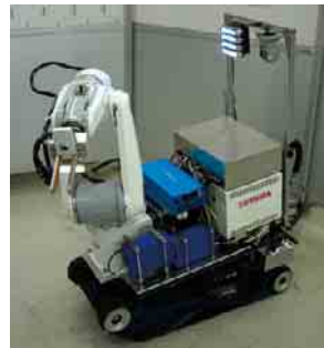
福島第一原子力発電所向けに 開発した多機能ロボット
