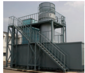
曝気レス水処理フィールド試験装置 (処理量30m 3 /日) (日本下水道事業団技術開発実験センター内)
