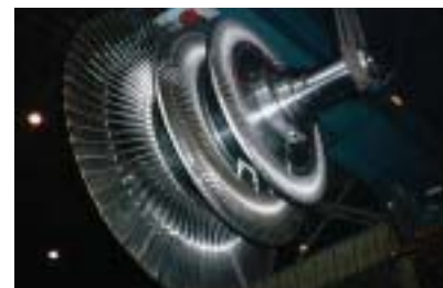
48インチ最終段シリーズ回転試験用ロータ
