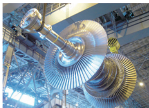
蒸気タービン Steam Turbine
