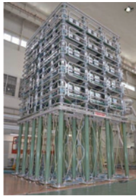
MMC方式を適用した 自動変換器バルブ MMC *1 Based VSC Valve *2 *1 MMC : Modular Multilevel Converter *2 VSC : Voltage Sourced Converter
