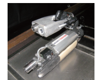
PCV ※1 内部調査装置 ※2 Investigation device for pressure containment vessel
